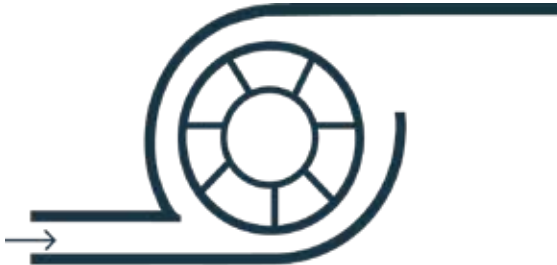
شكل 1 رمز مضخة طرد مركزي (Centrifugal Pump)
